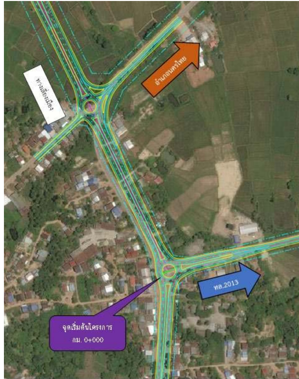
รูปที่ 6.3-1 รูปแบบทางแยกบริเวณจุดตัดทางหลวงหมายเลข 2013 จุดเริ่มต้นโครงการ (รูปแบบทางเลือกที่ 4)
